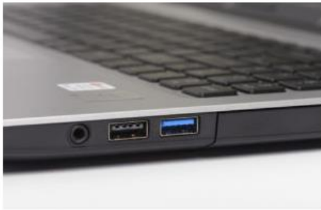
ノートパソコンのUSB 端子、左がUSB2.0、右がUSB3.0です。
